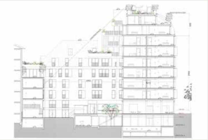
Coupe transversale, état projeté (©BLAU architectes).
