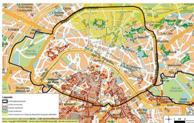
Figure 17 : Localisation du calcaire et du gypse souterrains à Paris
