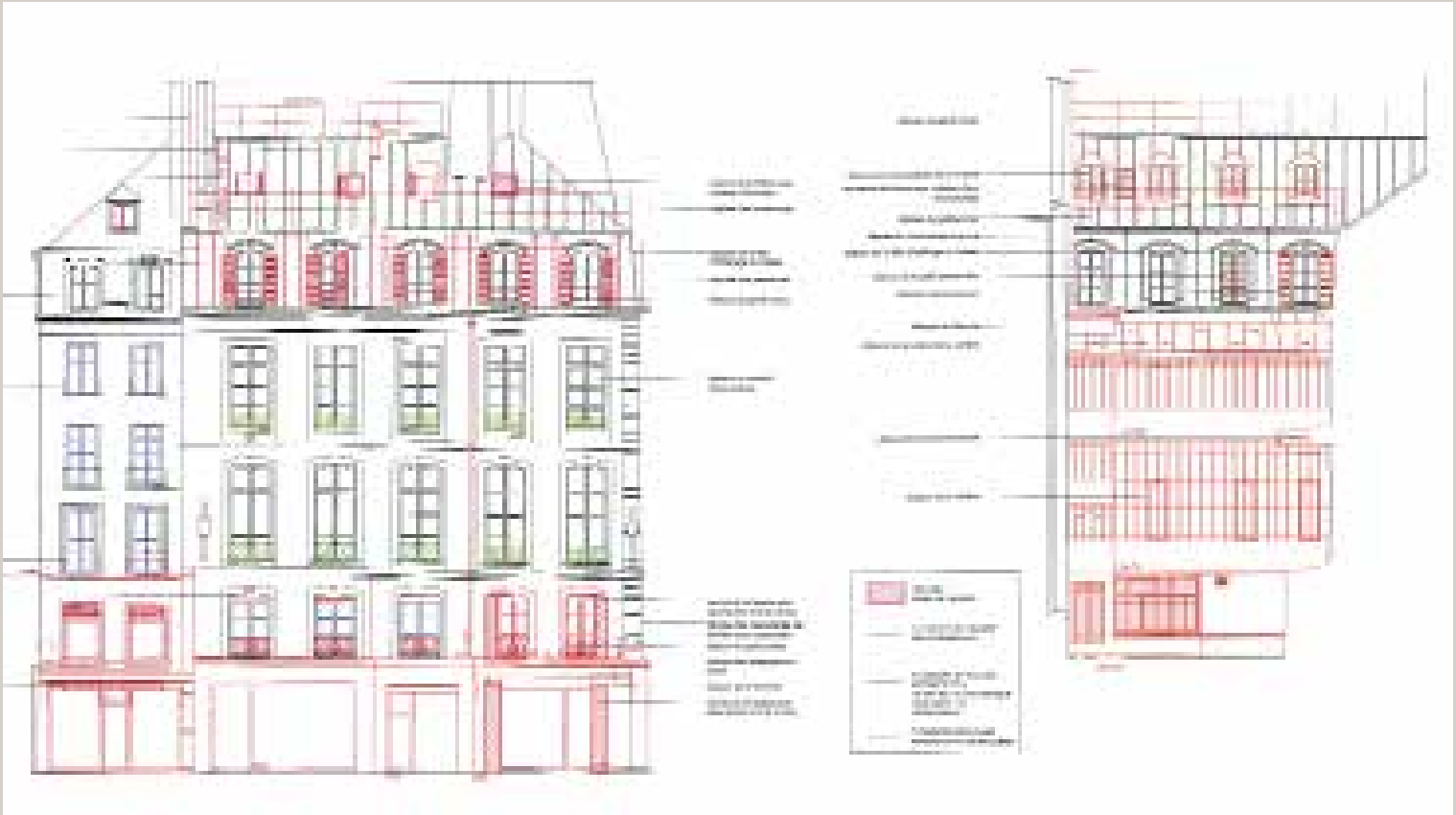
Façades sur rue la Saint-Honoré et son revers. En rouge et en bleu : les démolitions ; en vert les restaurations (© Viguier architectes).
