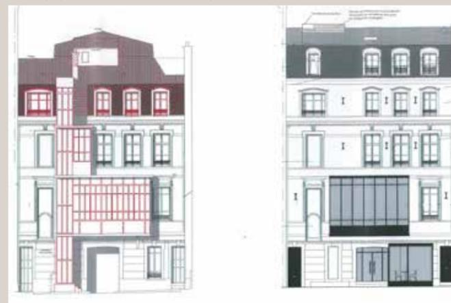
Élévation de la façade arrière du bâtiment sur rue, états existant (à gauche) et projeté (à droite) (© Global Architecture).
