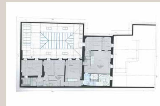
Plan projeté du deuxième étage montrant les nouvelles cages d'escalier et d'ascenseur (© Domela Architectes).
