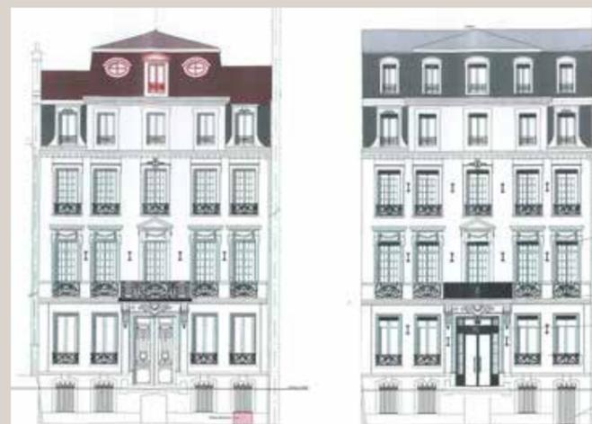
Élévation de la façade sur rue, états existant (à gauche) et projeté (à droite) (© Global Architecture).
