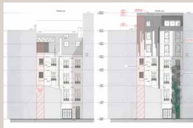
Élévation de la façade sur cour, état existant (à gauche) et état projeté (à droite) (© Équerre Architectes).
