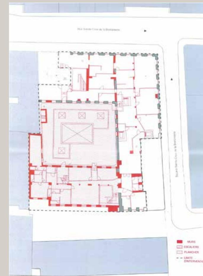
Plans des démolitions prévues du rez-de-chaussée à gauche et du R+1 à droite (© DATA Architectes).
