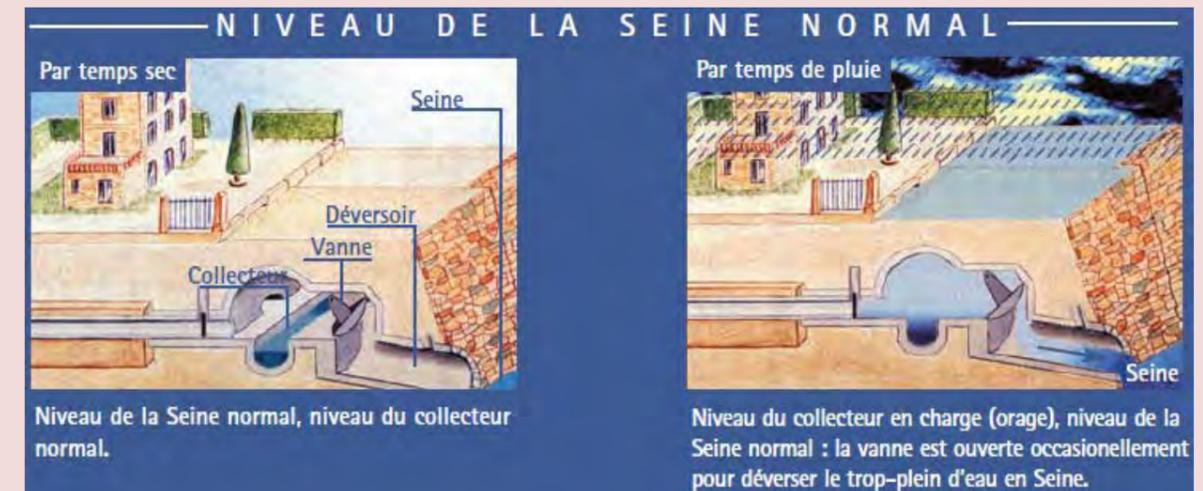
En cas de crue de la Seine et d'impossibilité d'évacuer les eaux directement par gravité via les déversoirs, un réseau secondaire prend le relais moyennant pompage.
