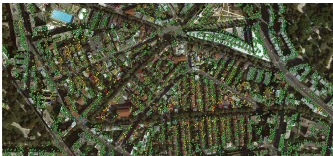
Mouvements mesurés dans le quartier des Amériques (Paris 19 e ) construit sur d'anciennes carrières de gypse.
