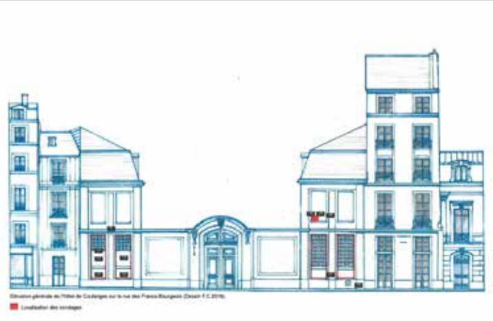
Localisation des sondages effectués dans le cadre de l’étude complémentaire des façades (© Sahuc & Katchoura / François Chatillon).
