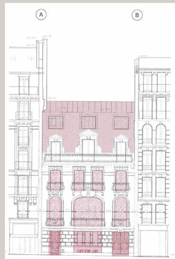
Repérage des démolitions en façade (© Braun + associés, architectes).
