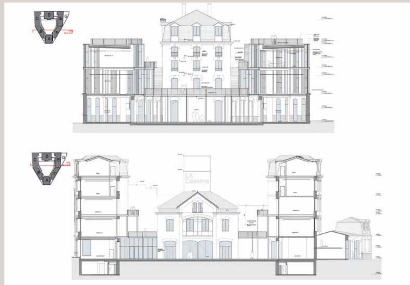
Élévation projetée du revers de la façade du bâtiment de tête (en haut) et élévation projetée de la façade du bâtiment au centre de la cour (en bas) (© Chaix et Morel).
