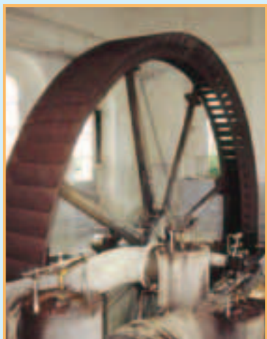
Usine de Villers-les-Rigault - roue turbine Girard.
