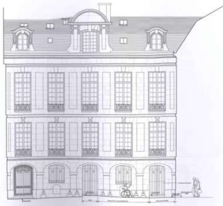
Ci-dessus : élévations de la façade de l'aile du fond (état actuel à gauche, état projeté à droite) : il est prévu de rouvrir une porte sous l'arcade de droite, et de créer une rampe d'accès PMR au droit des trois arcades de droite).
