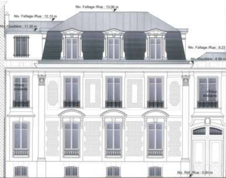
Ci-dessus : à gauche, élévation actuelle de la façade ; à droite, nouveau projet de façade, avec la création d'une porte d'entrée à la place de la fenêtre de gauche (documents Atelier Lilford Labruyère).
