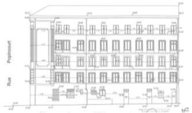
Ci-dessus : escalier, couloir et chambres. Ci-contre : élévations actuelle et projetée sur le passage Lisa. Les façades latérales seraient isolées par l'extérieur. En bas : façades actuelles depuis le passage Lisa et vers l'impasse des Trois-Sœurs ; perspective projetée sur l'impasse (documents Truelle, SCP d'Architecture).
