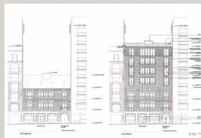
Élévation de la façade sur l'avenue, états existant (à gauche) et projeté (à droite) (© CD Architecture).
