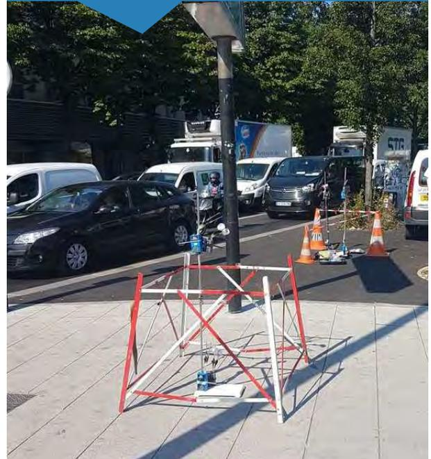
A la demande de la Direction de la Voirie et des Déplacements (DVD), le LPC a réalisé une étude au niveau de la porte d'Italie (13<sup>e</sup>) en vue de mesurer le « pouvoir dépolluant » de pavés récemment installés sur les trottoirs et ayant des propriétés spécifiques sur la qualité de l'air. Plusieurs polluants ont été mesurés, sur des sites avec et sans pavés, à des hauteurs différentes.
