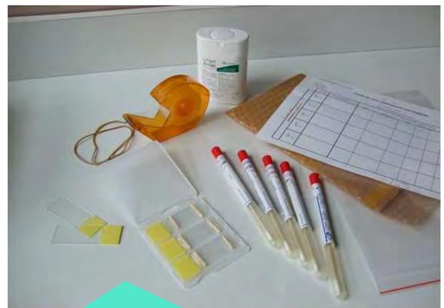
Kits composés d'écouvillons et de rubans adhésifs permettant d'identifier les moisissures présentes sur 5 supports échantillonnés, par deux techniques complémentaires
