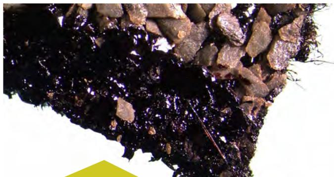
Fibres d'amiante dans un matériau bitumineux présent dans les enrobés
