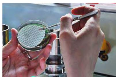
Dépôt de la membrane sur milieu spécifique après concentration de l'eau par filtration
