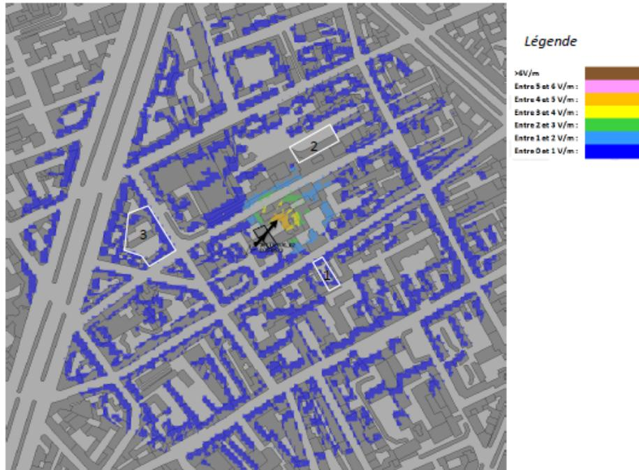
Pour l'antenne orientée dans l'azimut 220°, le niveau maximal calculé en intérieur est compris entre 4 et 5 V/m. La hauteur correspondante est de 11 m.
