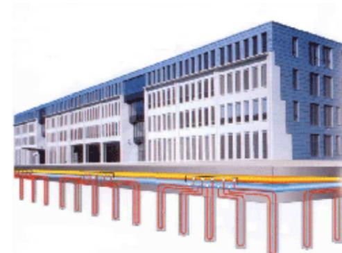
Fig. 5. Schéma d'utilisation de pieux géothermiques verticaux dans les fondations du bâtiment
