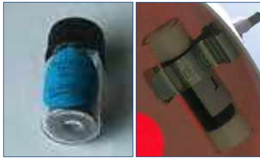
Figure 13 : Tubes passifs à BTEX (mesure du benzène)
