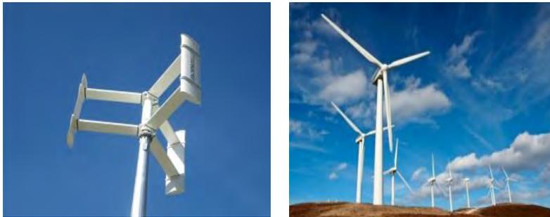
Eoliennes à axe vertical et horizontal
