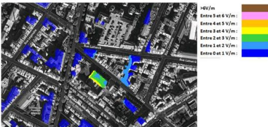
Pour l'antenne orientée dans l'azimut 270°, le niveau maximal calculé est compris entre 3 et 4 V/m. La hauteur correspondante est de 24m.
