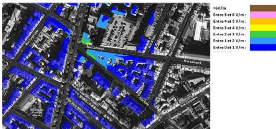
Pour l'antenne orientée dans l'azimut 110°, le niveau maximal calculé est compris entre 3 et 4 V/m. La hauteur correspondante est de 25m.
