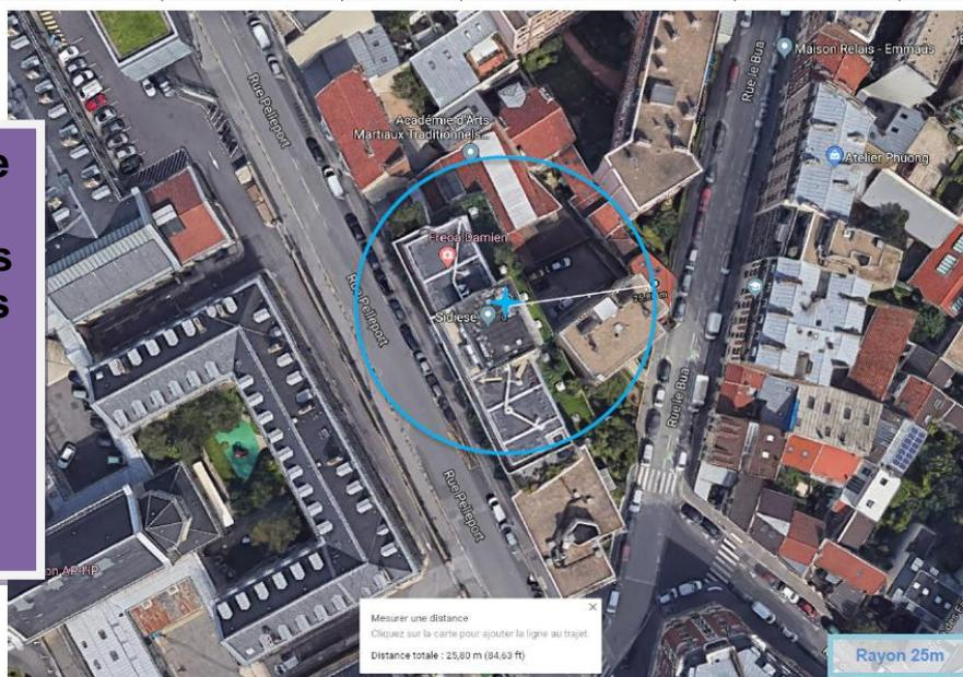
Dans un rayon de 25m, la hauteur au niveau des antennes est supérieure à tous les bâtiments alentours. Il n'y a donc aucun bâtiment en vue directe depuis les 3 azimuts.
