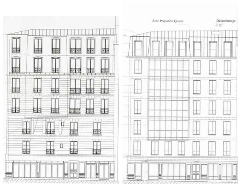
*Ci-dessus, élévations côté quai de Jemmapes (état existant à gauche et état projeté à droite) : le bow-window maçonné allant du troisième au dernier étage est remplacé par un bow-window métallique et vitré commençant un étage plus bas. Plutôt qu'aux ateliers artisanaux du quartier, son dessin se réfère à la veine néo-haussmannienne des années 80. Ci-dessous, vue actuelle et perspective du projet.*
