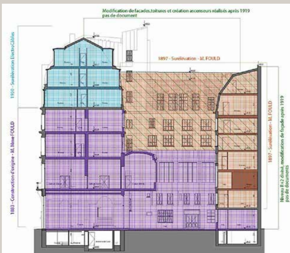
Repérage des campagnes de construction. En violet, l'hôtel Fould, par E. Sanson, 1883 ; en orange, les surélévations de H.-P. Nénot (1898) et en bleu, la surélévation de 1930 (L. Plousey et U. Cassan) (© Vincent Hérault, architectes).
