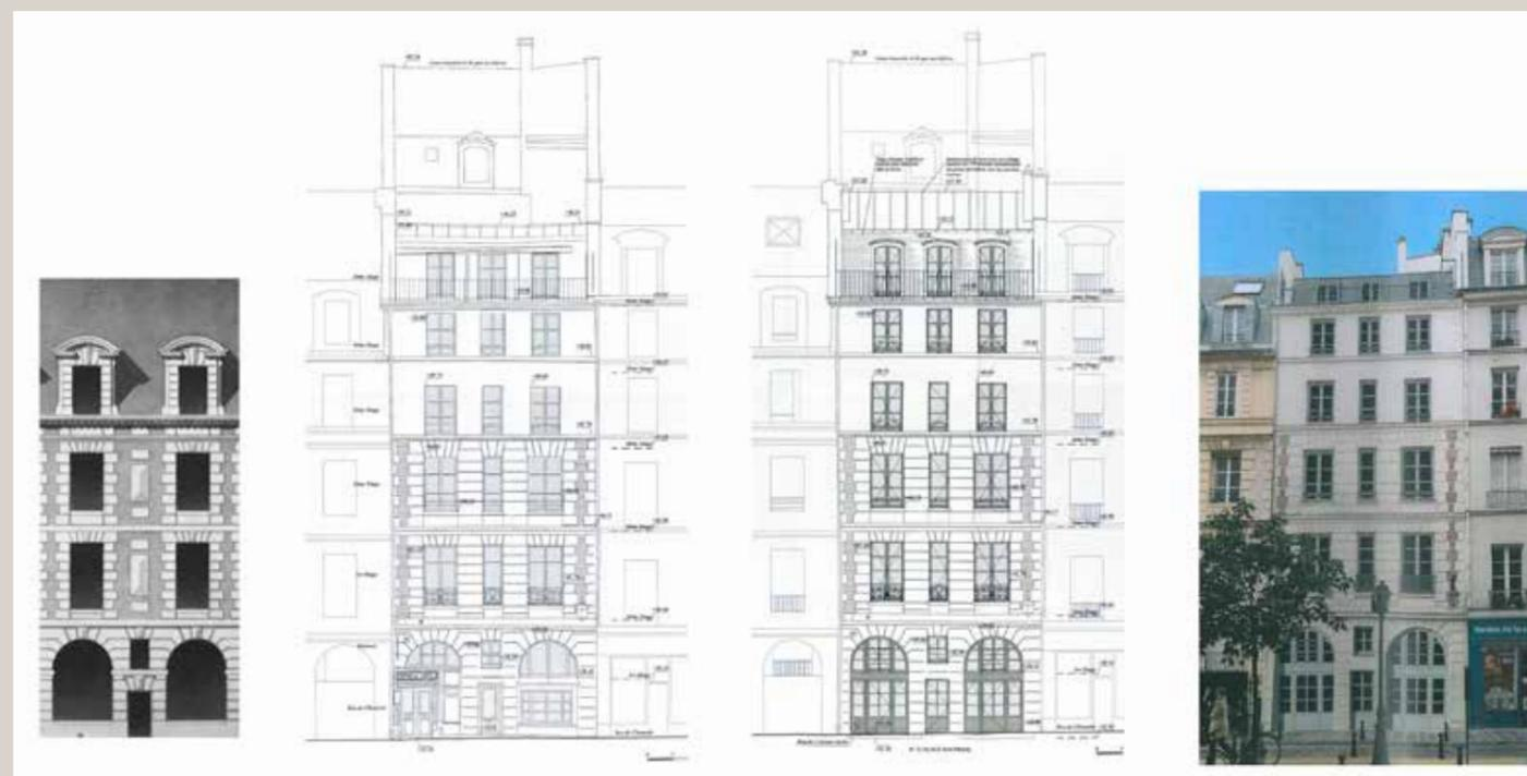
Ci-dessus, de gauche à droite : restitution de l'élevation type d'origine de la place Dauphine ; élévation actuelle du 25, place Dauphine ; élévation projetée et vue d'insertion du projet (© G.M.D.P. Architecture). Le projet conserve dans les étages l'élévation actuelle mais crée au rez-de-chaussée un état qui n'a jamais existé.
