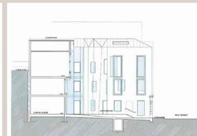
Coupes longitudinales actuelle à gauche et projetée à droite (© VISIBLE, Guillaume Bellanger architecte). Les façades projetées sur rue et en retour seraient construites en béton à parement de plaquettes de brique. Sur cour, le projet annonce une façade pliée de verre et de brique.
