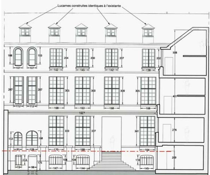
*Ci-dessus : élévation, première et seconde versions du projet. La lucarne existante au centre est conservée et les nouvelles lucarnes sont créées sur son modèle.*
