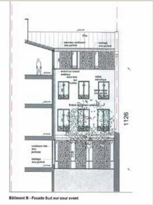
Élévations existante, à gauche, et projetée, à droite (© Verdier + Rebière architectes). Le comble serait rehaussé et la façade serait isolée par l'extérieur.
