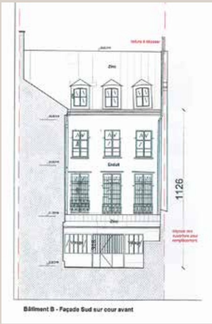
Élévations existante, à gauche, et projetée, à droite (© Verdier + Rebière architectes). Le comble serait rehaussé et la façade serait isolée par l'extérieur.
