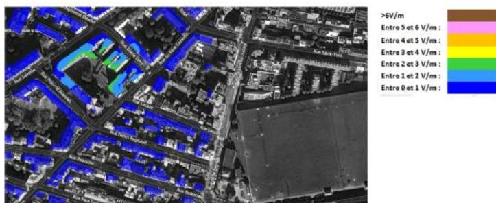
Pour l'antenne orientée dans l'azimut 135°, le niveau maximal calculé est compris entre 2 et 3 V/m. La hauteur correspondante est de 21m.
