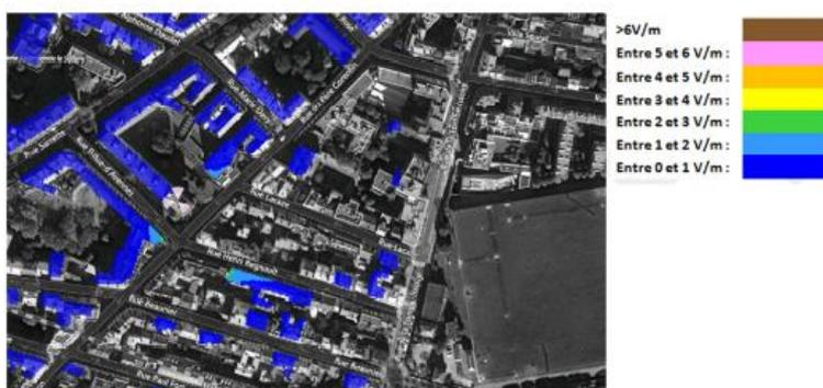
Pour l'antenne orientée dans l'azimut 260°, le niveau maximal calculé est compris entre 2 et 3 V/m. La hauteur correspondante est de 24m.
