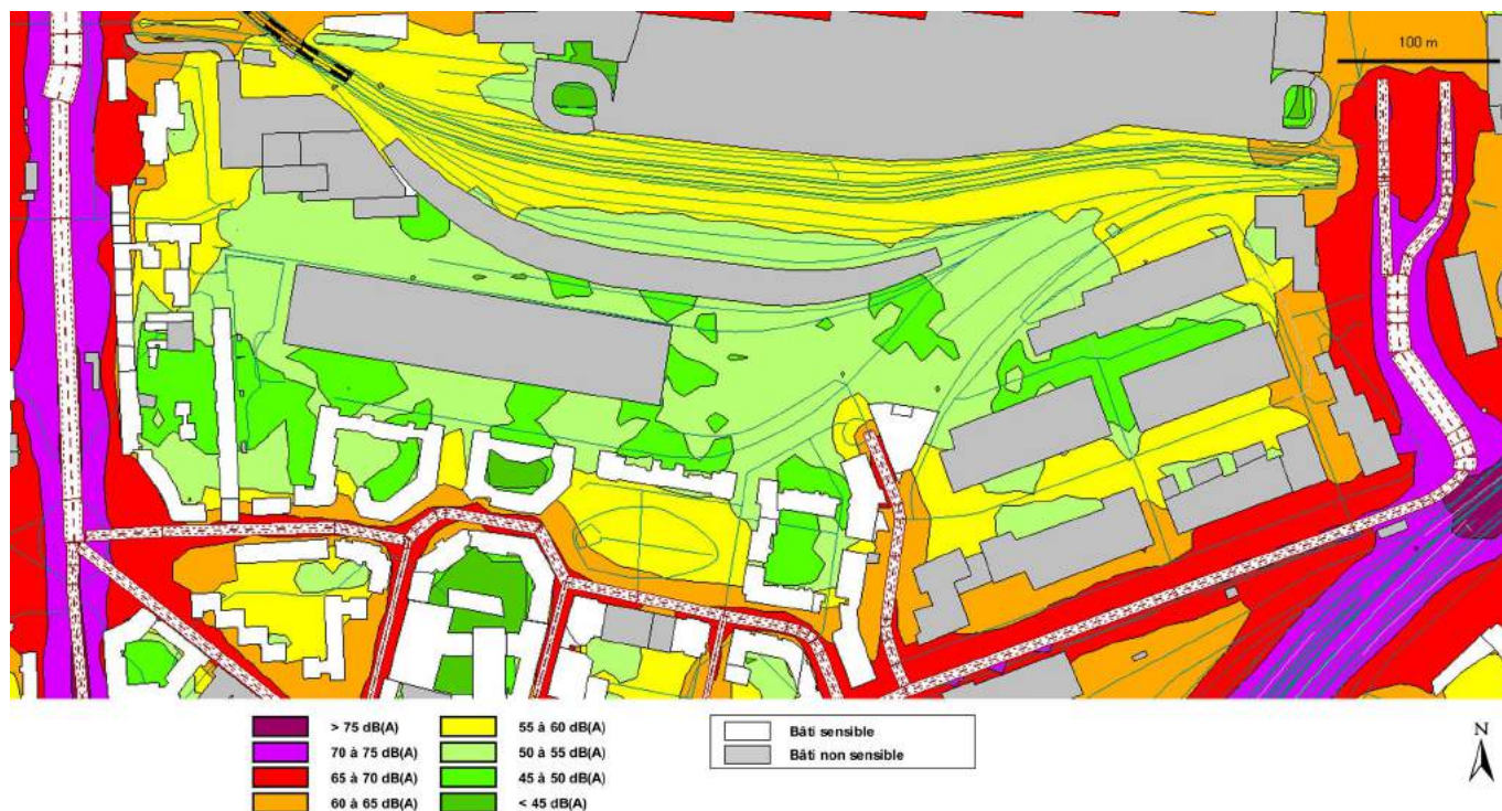
Bruit LAeq en période diurne à 4 m du sol (source Acouphen, 2017)
