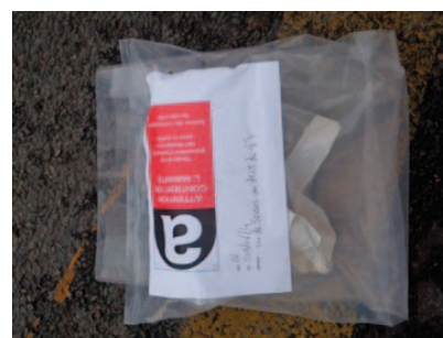
Prélèvement de matériaux pour analyser une éventuelle présence d'amiante – © Mairie de Paris, DVD
