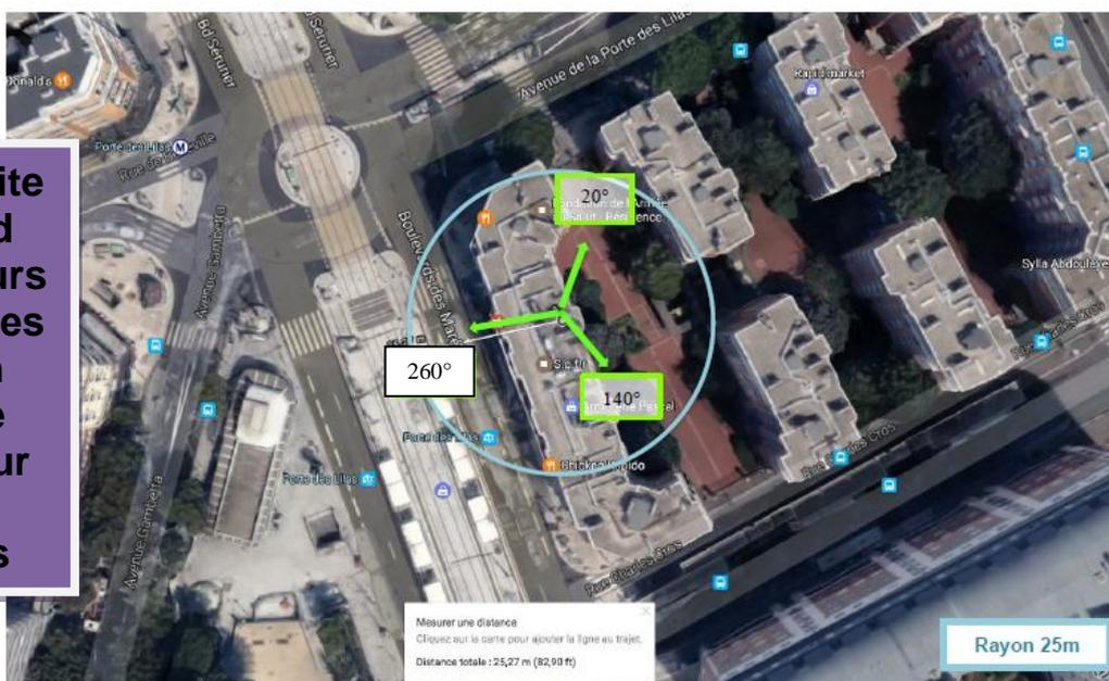
Dans un rayon de 25m, la hauteur au niveau des antennes est supérieure à tous les bâtiments alentours. Il n'y a donc aucun bâtiment en vue directe depuis les 3 azimuts.
