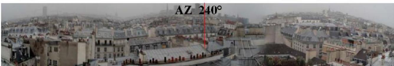
Secteur 3 – Az 240°, aucun bâtiment à moins de 25 mètres dans l'azimut de nos antennes.
