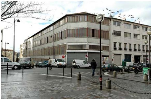
Cet ensemble de bâtiments d'activités, construction élémentaire en charpente à allèges en maçonnerie et remplissages vitrés, sera démolé et remplacé par la construction d'une résidence étudiante.
