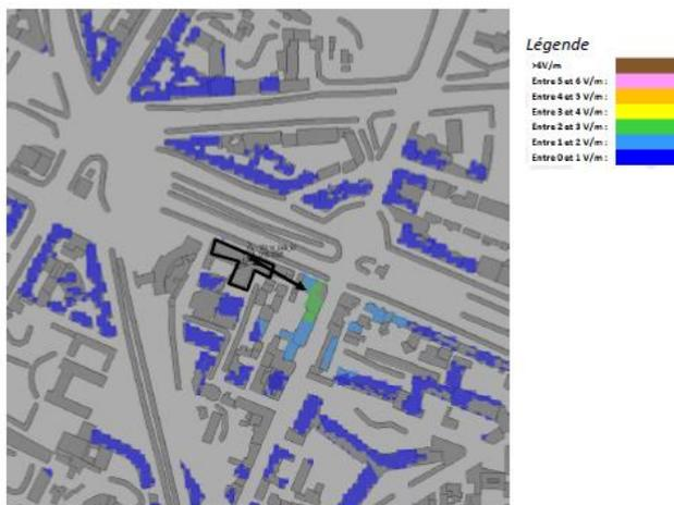
Pour l'antenne orientée dans l'azimut 230°, le niveau maximal calculé en intérieur est compris entre 3 et 4 V/m. La hauteur correspondante est de 18 m.
