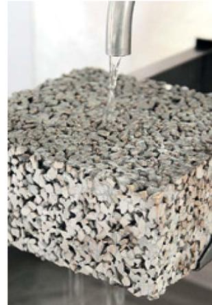
Hydromedia : revêtement poreux à base de liant en béton fortement drainant (photo Lafarge bétons)
