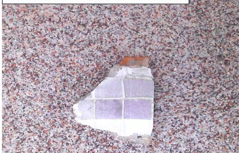
COMPARAISON ENTRE PÂTE DE VERRE EXISTANTE ET ENDUIT TYPE GRAIN DE MARBRE DANS LA TEINTE LA PLUS PROCHE
