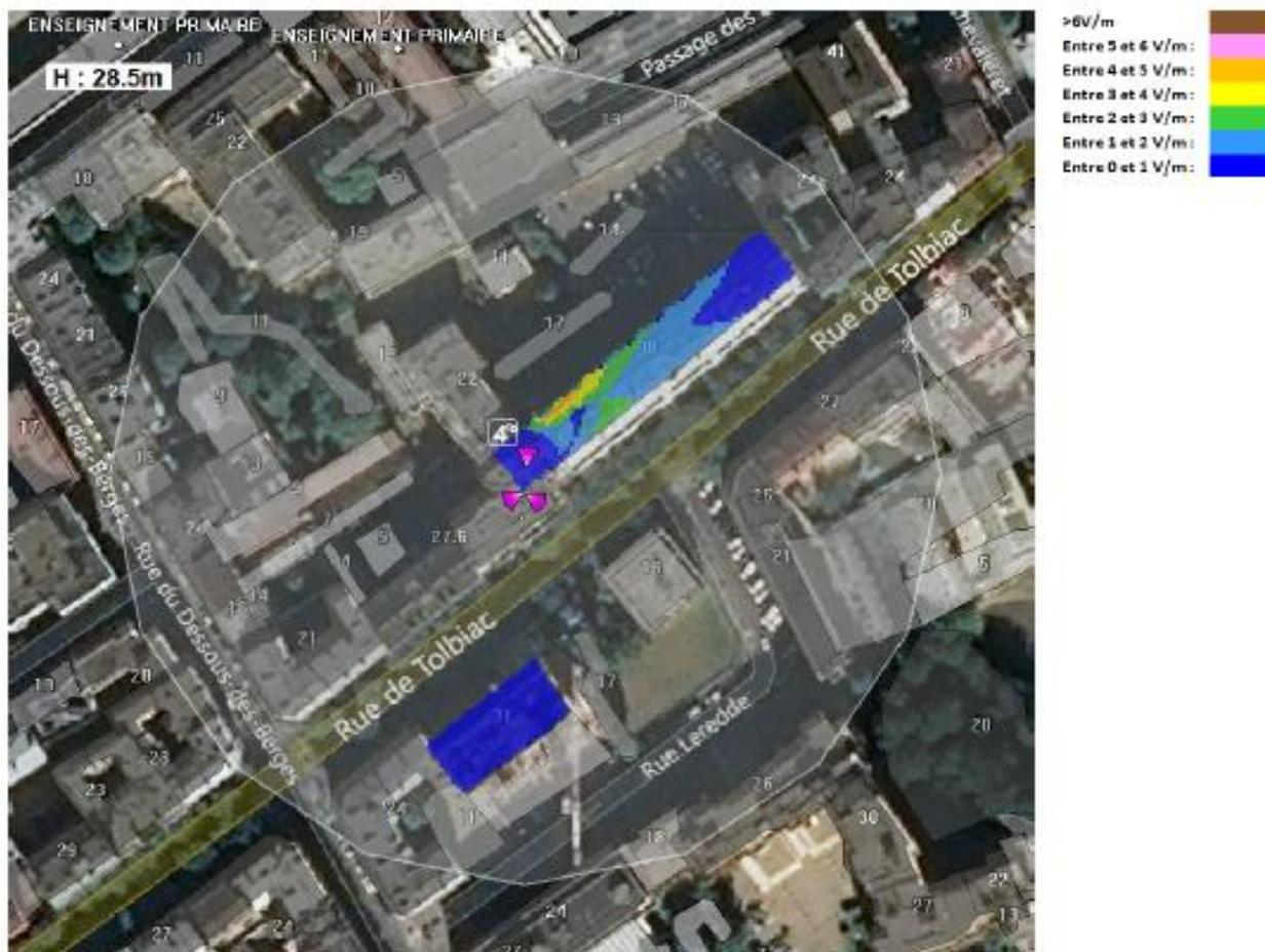
Pour l'antenne orientée dans l'azimut 121°, le niveau maximal calculé est entre 2 et 3 V/m. La hauteur correspondante est de 19.50m.
