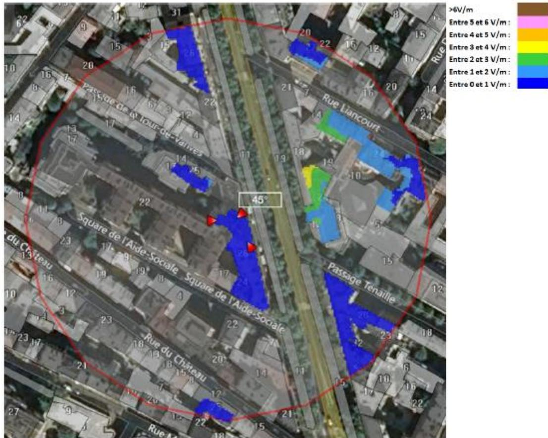
Pour l'antenne orientée dans l'azimut 150°, le niveau maximal calculé est compris entre 4 et 5 V/m. La hauteur correspondante est de 25.50m.
