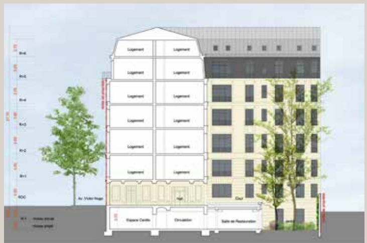
Coupe transversale, état projeté présentant le creusement de la cour (© Lanctuit Architectes).
