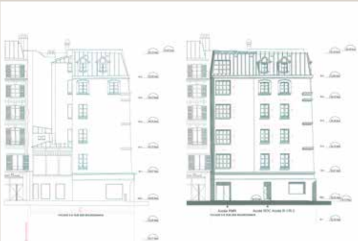
Élévation de la façade sur la rue des Bourdonnais, états existant (à gauche) et projeté (à droite) (© SAS FH Architecture).
