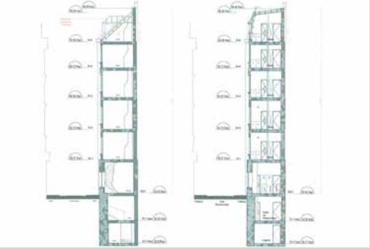
Coupe longitudinale, états existant (à gauche) et projeté (à droite) (© SAS FH Architecture).
