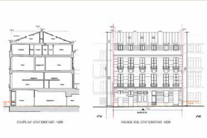
Coupe longitudinale et élévation de la façade sur rue, état existant (© Architecture Consultant).
