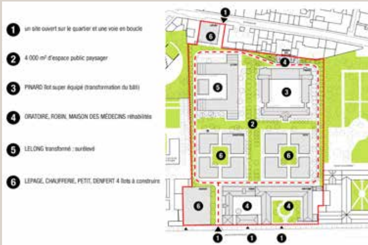
Plan schématique présentant les fondements du projet (© Anyoji Beltrando).
