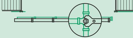
Les canalisations sont protégées, sous la chaussée, par un coffrage en béton armé.
