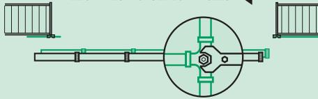
Les canalisations sont protégées, sous la chaussée, par un coffrage en béton armé.
