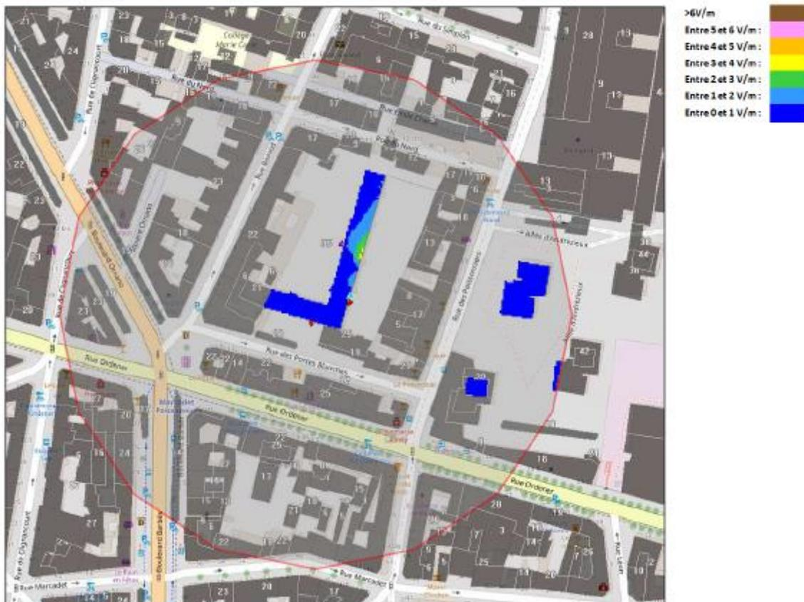
Pour l'antenne orientée dans l'azimut 150°, le niveau maximal calculé est compris entre 1 et 2V/m. La hauteur correspondante est de 31.50m.
