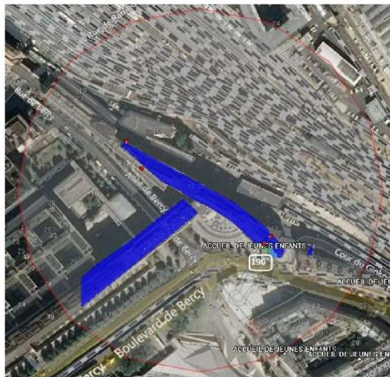
Pour l'antenne orientée dans l'azimut 260°, le niveau maximal calculé est compris entre 1 et 2 V/m. La hauteur correspondante est de 25.50m.
