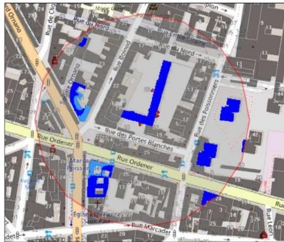
Pour l'antenne orientée dans l'azimut 300°, le niveau maximal calculé est calculé inférieur à 1V/m. La hauteur correspondante est de 22.50m.
