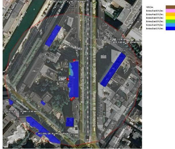
Les simulations en espace libre indiquent les niveaux maximums suivants par antenne :
