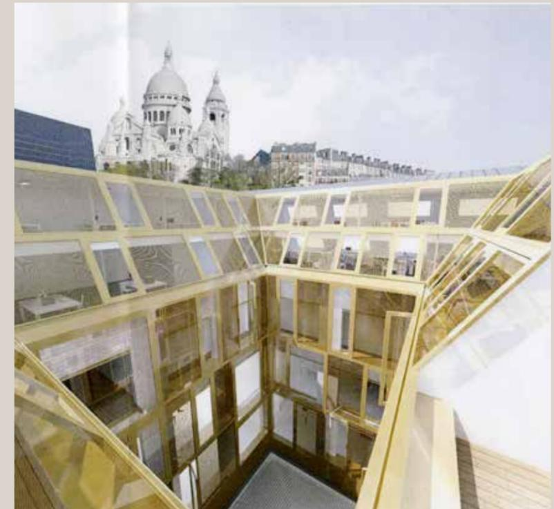
Vue perspective de l'état projeté de la cour. Une seconde façade de métal et de verre double les façades anciennes en brique conservées ; les menuiseries métalliques sont déposées (© Moussafir architectes associés).
