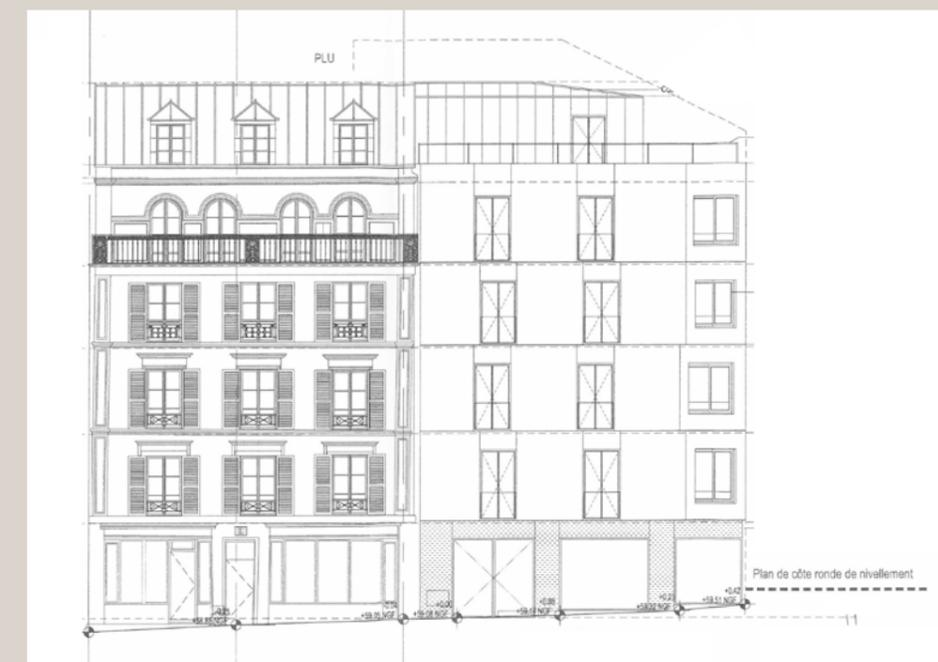
Élévation projetée de l'immeuble conservé à gauche et de l'immeuble neuf à droite (© Atelier Téquy, architecture). Au n° 5, rue Myrha, des devantures en applique seraient restituées.
