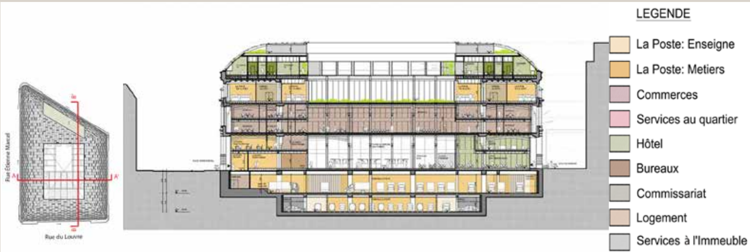
Coupe transversale, état projeté (© Dominique Perrault Architecture).
