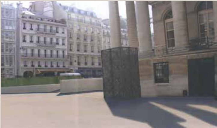
Extrait du permis de construire présenté en séance du 9 juin 2011, montrant le monte-charge extérieur projeté (© Wilmotte & associés SA). Cette solution est aujourd'hui abandonnée.
