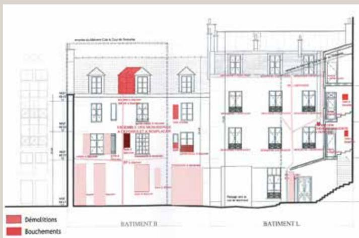
Repérage des modifications prévues sur les façades arrière de la maison XVIII<sup>e</sup> (à gauche de l'image) et celle de 1867 (à droite de l'image) (© OdC architectes).
