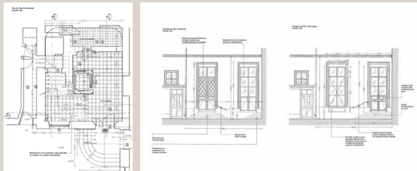
À gauche, vue projetée en plan du départ de l'escalier, figurant le perron déplacé et sa nouvelle entrée, ainsi que l'ascenseur.
