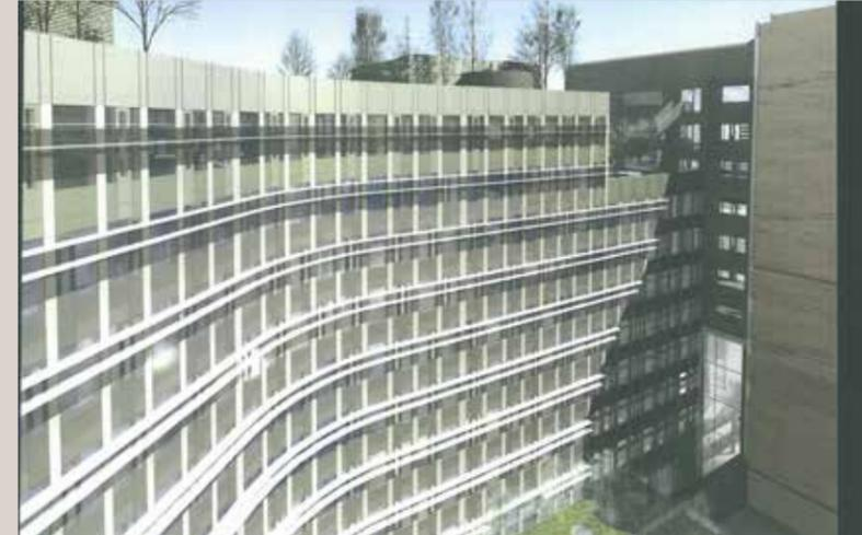
Perspective de la façade projetée du bâtiment sur cour (© Franck Hammoutène, architecte). La structure serait conservée mais recouverte ; le mur rideau serait remplacé.
