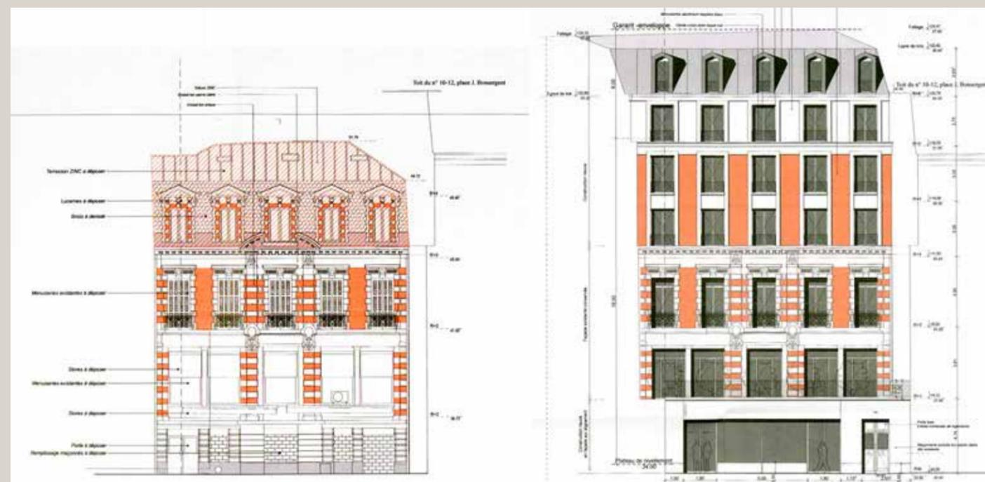
Élévations actuelle (à gauche) et projetée (à droite) (© Exp-Art architecture). Une surélévation de trois étages carrés plus un comble remplacerait le comble existant. Le socle de l'édifice serait prolongé jusqu'à l'alignement sur rue.
