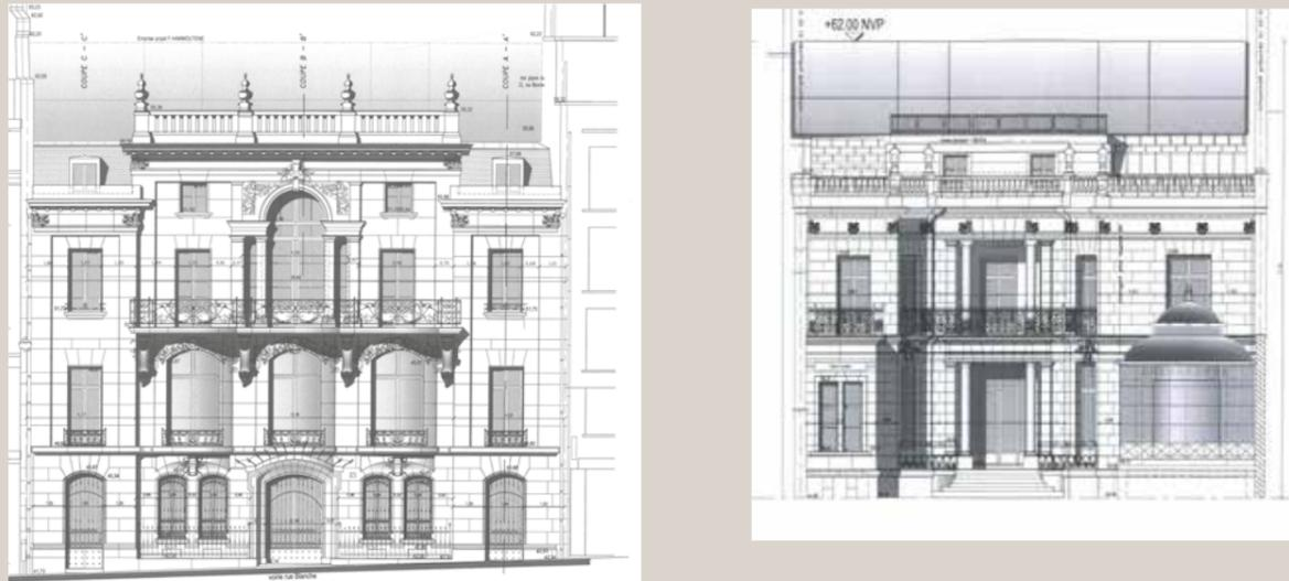
A gauche, élévation de la façade projetée sur rue et, à droite, côté jardin (© AC. Perrot, F. Richard et F. Hammoutène architectes).
