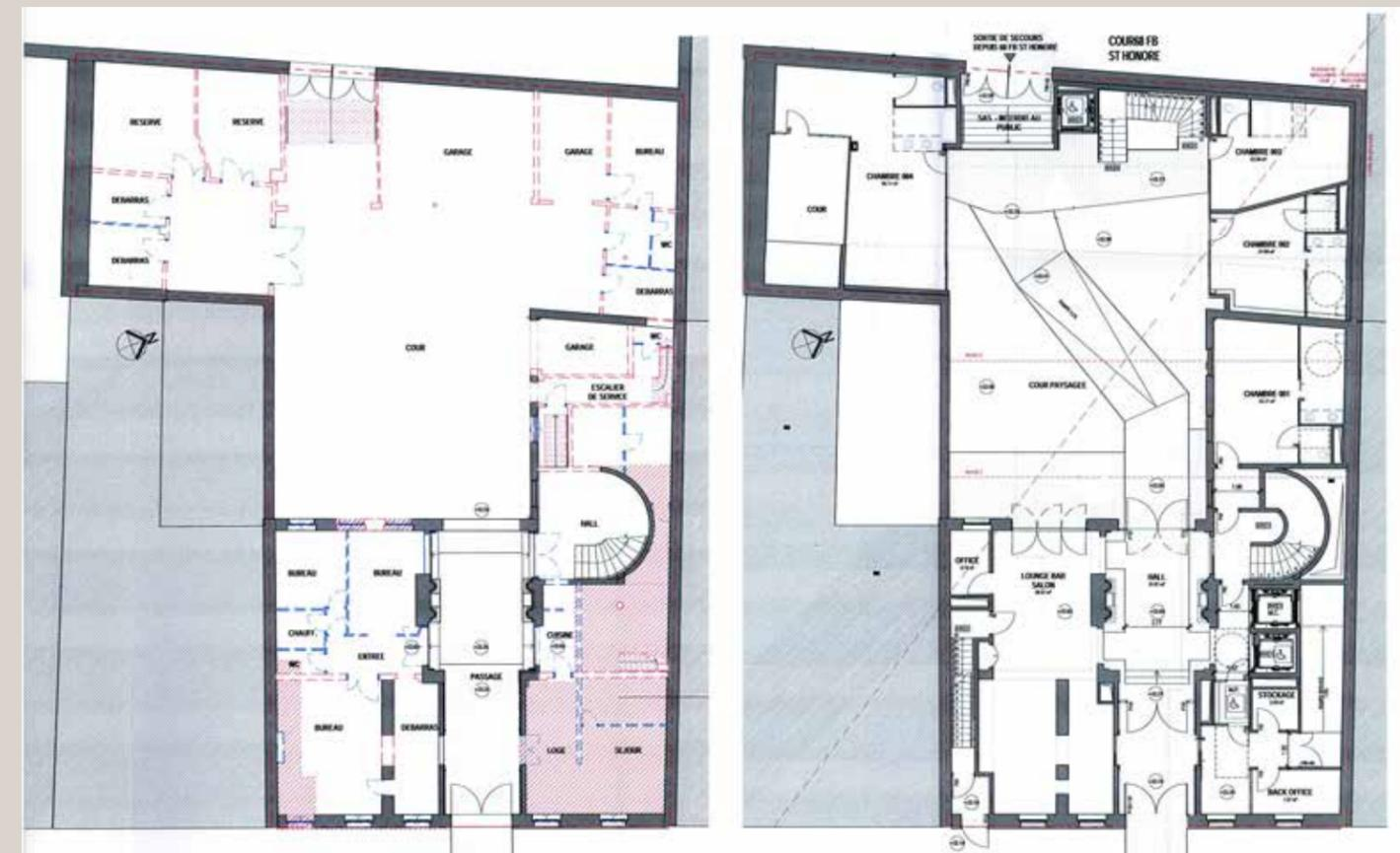
Plans du rez-de-chaussée : à gauche, l'état actuel avec repérage des démolitions ; à droite, état projeté (© STUDIOS architecture).
